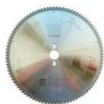
Пила дисковая Leitz FormaCut-AS HW: 300x3,2x30, Z96/FZ/TR
